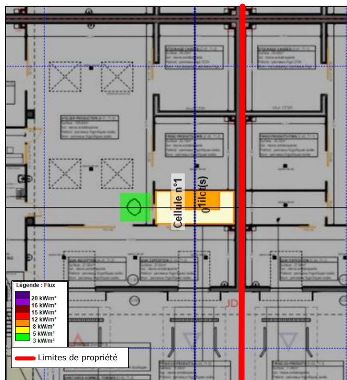
Figure 3. Représentation graphique effets thermiques générés par un incendie sur le stockage frigorifique des co-produits
